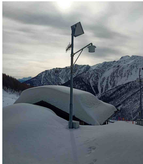
Stazione meteorologica automatica (AWS) posizionata a Crévacol a 2018 m dotata di nivometro, termometro aria e pluviometro.
