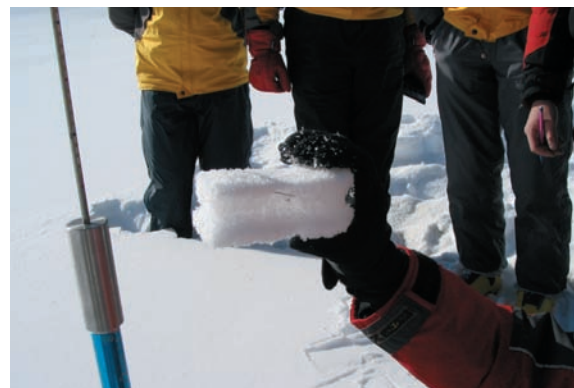
Figura 2.3.10 - Esempio di crosta (foto SAGF).
