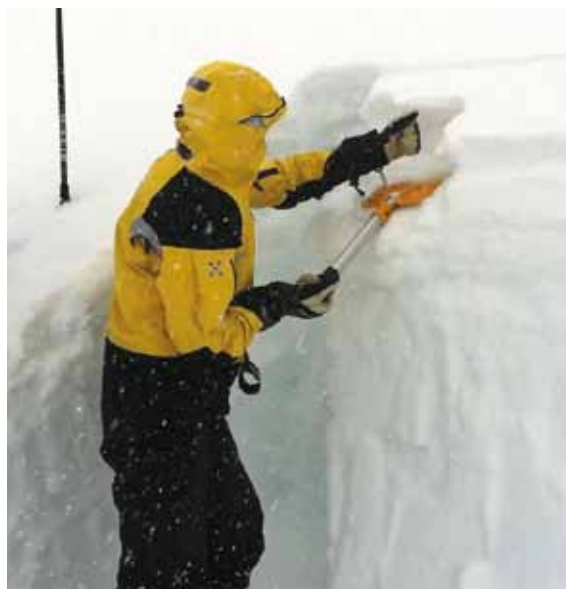
■ Esecuzione del test di stabilità "Extended column Test".
