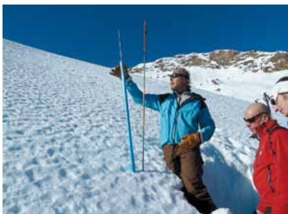
■ Esecuzione di un profilo penetrometrico.
