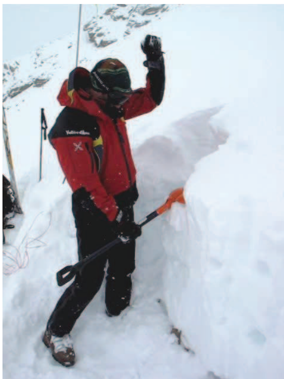
■ Esecuzione del test di stabilità "Extended Column Test".
