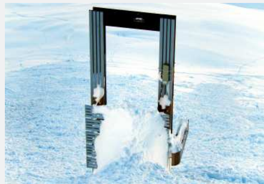
■ Fig. 6.16: forma del deposito a monte dell'ostacolo (evento del 20/01/2014). La superficie d'impatto di area pari a circa 1 m 2 è tale da rappresentare una porzione significativa di una costruzione reale.
