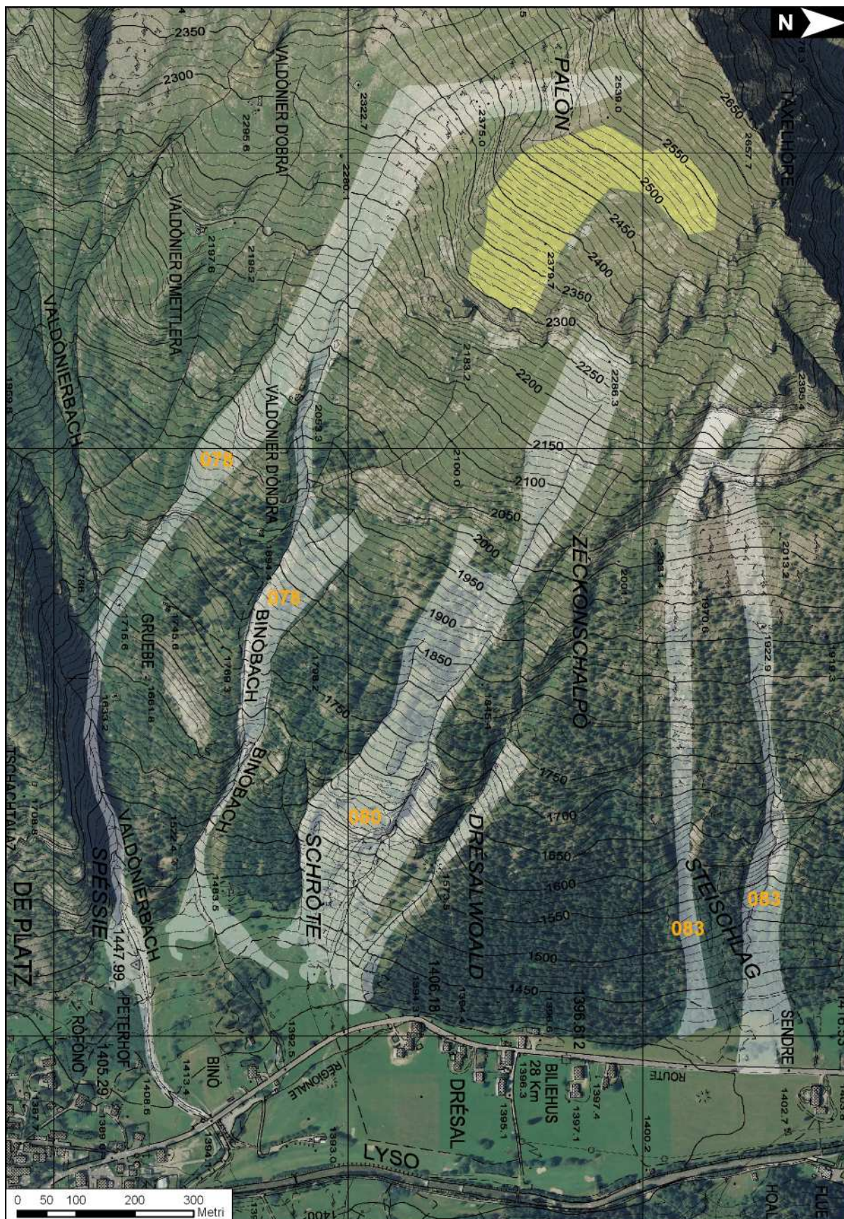
■ Fig. 4.85: estratto cartografico delle valanghe 01-078 e 01-080, scese il 10 marzo 2014, e della valanga 01-083, verificatasi il giorno seguente. Sia l'area di distacco che quella di accumulo rientrano abbondantemente nei limiti storici conosciuti per questi fenomeni. La campitura gialla delimita l'area di 6 ettari interessata dalle 90 buche a gradoni utili come difesa attiva contro il distacco delle masse nevose nella parte alta del bacino valanghivo.
