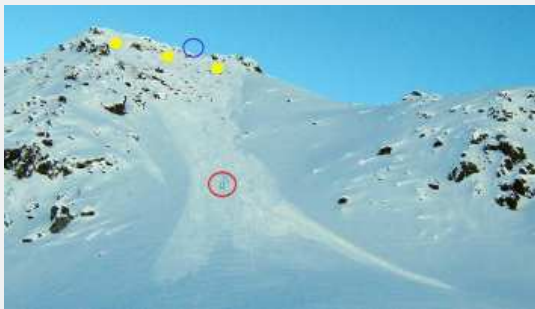
■ Fig. 6.15: sito sperimentale di Punta Seehore (evento del 06/02/2014). In giallo sono evidenziati i punti di tiro, in blu il palo dello snowdrift e in rosso l'ostacolo.
