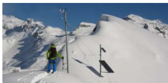
■ Fig. 6.11: il palo strumentato per il monitoraggio del trasporto eolico a Punta Seehore.
