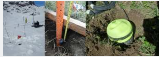
■ Fig. 6.8: il sito “Sant’Anna II” in inverno con particolare degli iButton e delle celle di carico.
