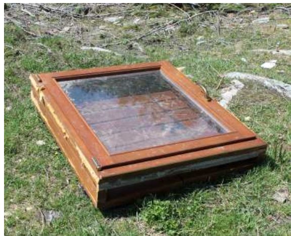
■ Fig. 4.47: l'ultima delle cinque finestre del bivacco trasportata dal fenomeno valanghivo. Da notarne l'integrità. La particolarità sta nella sua posizione: si trova infatti localizzata ad una decina di metri di distanza rispetto agli altri detriti del bivacco rimasti in loco. Sicuramente lo scalzamento della finestra è stato dovuto anche allo scarso vincolamento del telaio alla muratura, mentre il suo spostamento è da imputare al fenomeno valanghivo.
