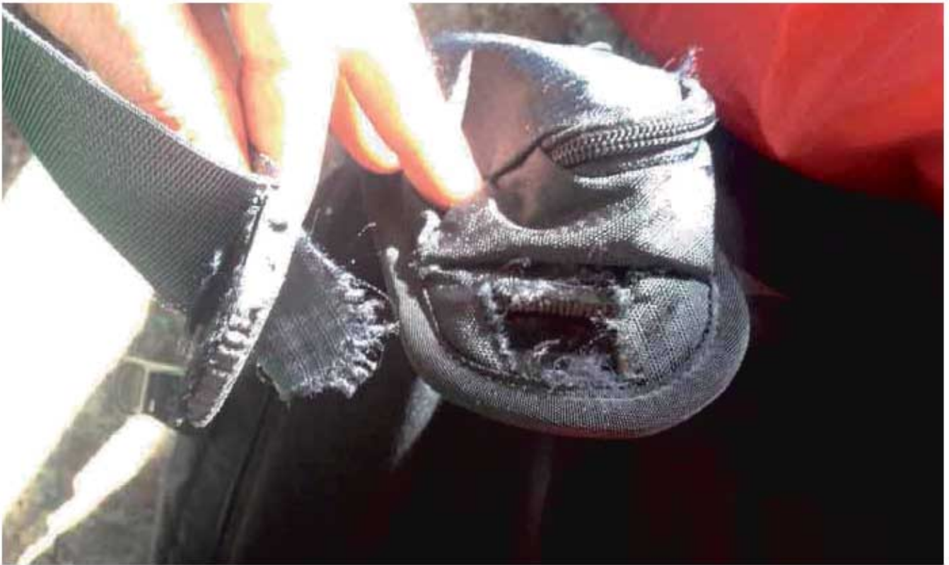
■ Fig. 5.14: particolare della rottura della cintura ventrale dello scaino airbag.
