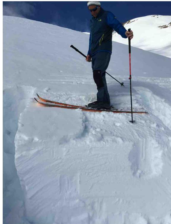
*Test del blocco di scivolamento con parziale rottura del blocco.*
