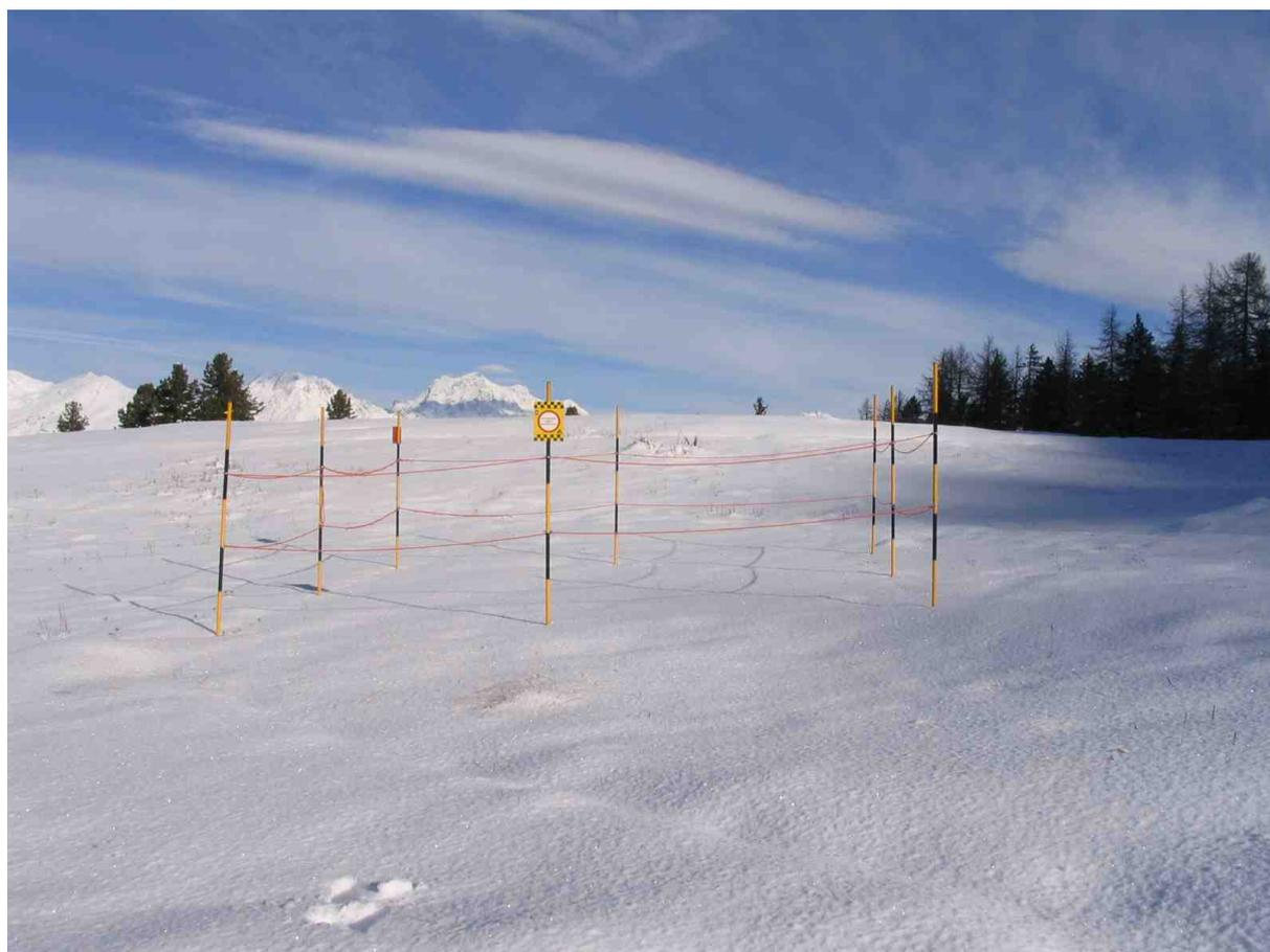
*Allestimento di un campo neve fisso per l'effettuazione di rilievi nivologici Modello 2-3-4 AINEVA.*
