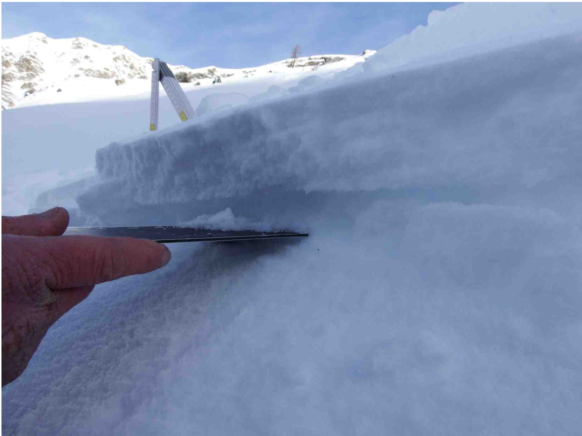
Figura 3.9: il 15 dicembre durante un rilievo nivologico nel comune di Rhemes-Notre-Dame si nota in superficie un sottile strato di neve più compattato a causa dell'azione del vento. Al di sotto di questo si evidenzia la presenza di pochi centimetri di neve meno compressa. Questa stratificazione del manto può dare problemi di instabilità se altre nevicate aggiungono nuova neve (foto Parco nazionale del Gran Paradiso).
