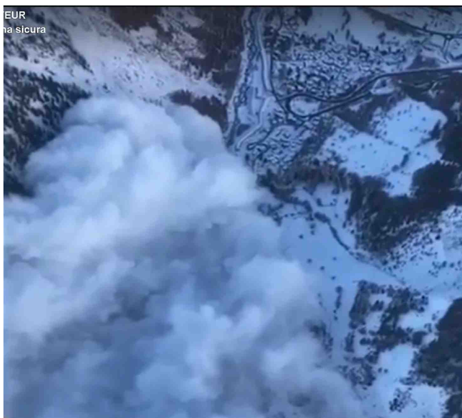
Figura 3.33: parte finale della corsa della valanga originata artificialmente il 5 febbraio per bonificare il bacino del Marbrée dalla Commissione locale valanghe nell’ambito del PIDAV comunale. La componente nubiforme, la cui velocità raggiunge valori superiori ai 200 km/h, arriva quasi alla Palud di Courmayeur (foto Commissione locale valanghe).
