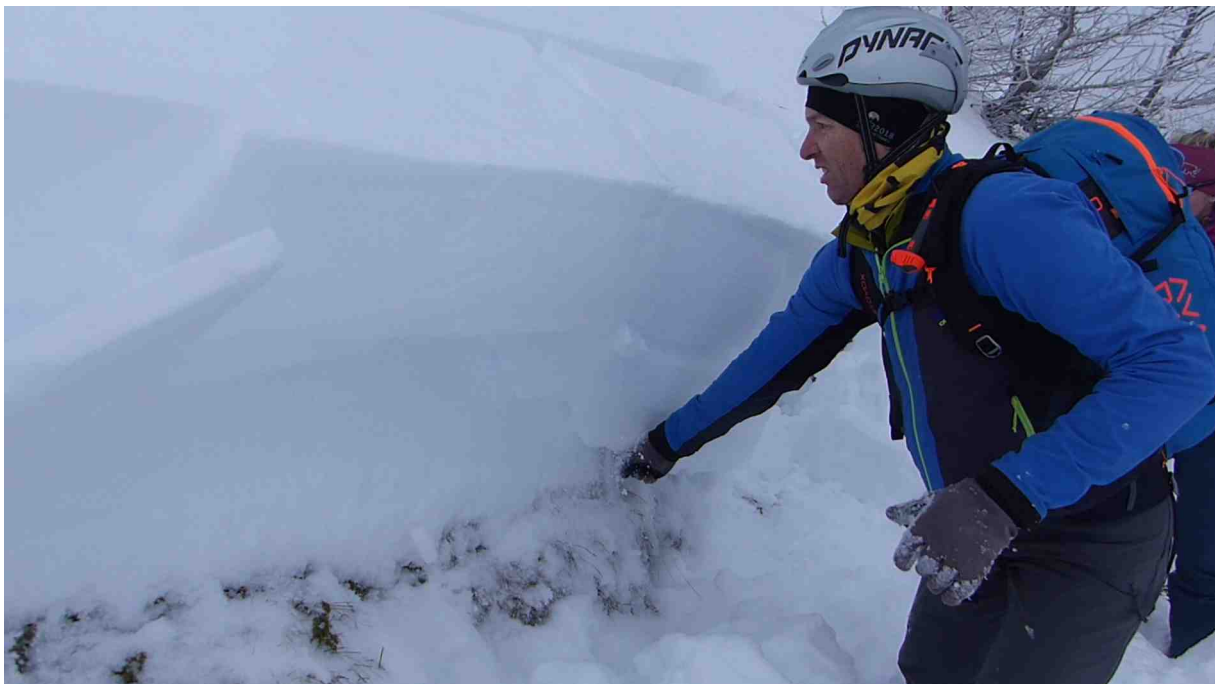
Test di stabilità nella zona di distacco effettuati il giorno dopo l'incidente. In questa immagine si evidenzia il secondo strato debole partendo dall'alto, quello presente in profondità, quasi alla base del manto nevoso.
