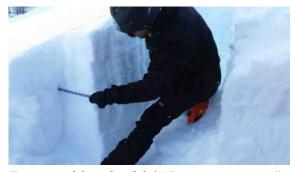
Esecuzione del test di stabilità "Propagation saw test".
