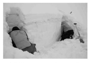
Taglio del blocco 180x30cm per l'esecuzione dei test di stabilità di due colonne estese (ECT).
