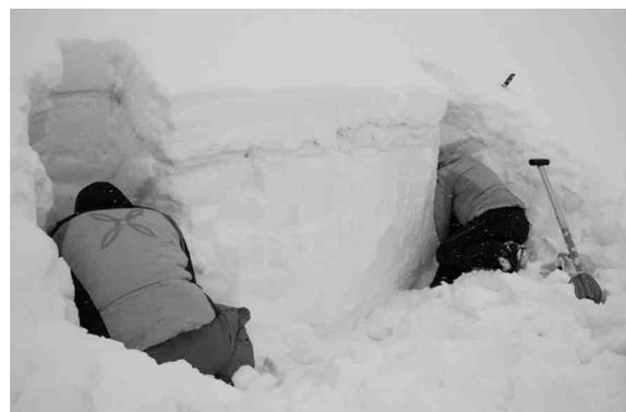
Taglio del blocco 180x30cm per l'esecuzione dei test di stabilità di due colonne estese (ECT).
