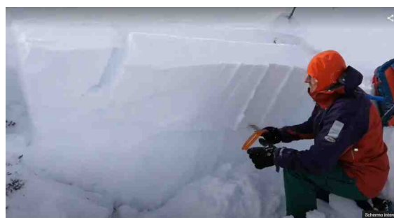
Esecuzione del test di stabilità "Propagation saw test".
