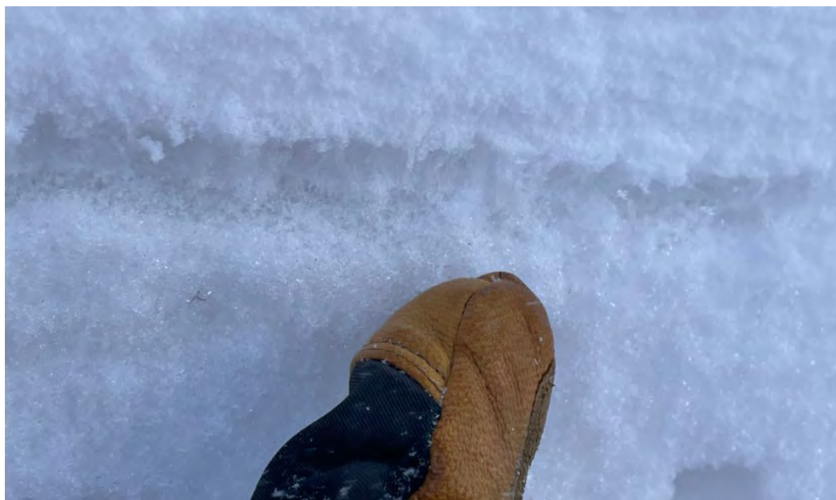
Figura 5.12: strato di brina di superficie inglobata nel manto nevoso da una nevicata di inizio dicembre di circa 20 cm. Instabilità documentata durante il rilievo itinerante effettuato nel Comune di Courmayeur nelle vicinanze del comprensorio sciistico nella Val Veny (vedi Fig. 5.11)
