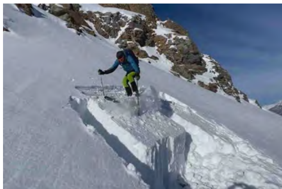
Un rilevatore durante l'esecuzione di un test del blocco di scivolamento 200 cm x 150 cm (RB).
