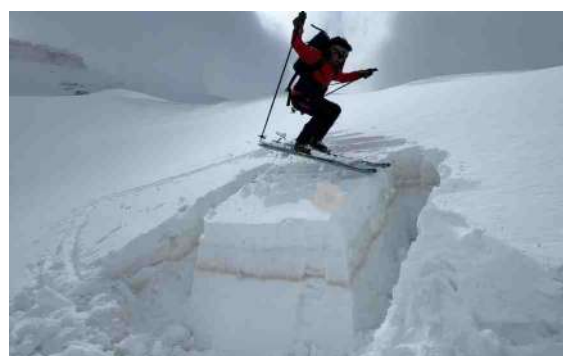
Un rilevatore durante l'esecuzione di un test del blocco di scivolamento 200 cm x 150 cm (RB).
