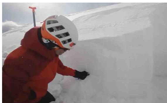
Esecuzione del test di stabilità "Propagation saw test".
