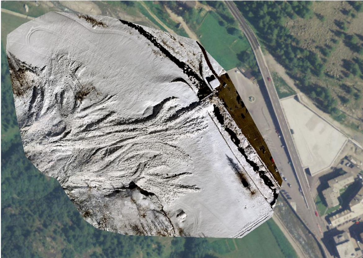
Figura 5.42: la valanga 01-114 di Testa Grigia (Gressoney-La-Trinité) del 3 marzo rilevata tramite drone (Nucleo SAPR Regionale). La valanga raggiunge il letto del Lys con la componente densa. Con la componente nubiforme lambisce l'abitato di Eselbode e il parcheggio che separa la valanga dalla strada regionale.
